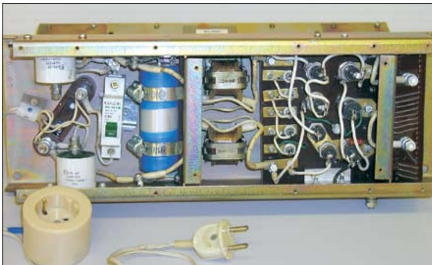
Рис. 2 Сетевой фильтр ввода питания релейных шкафов – ФСРШ
