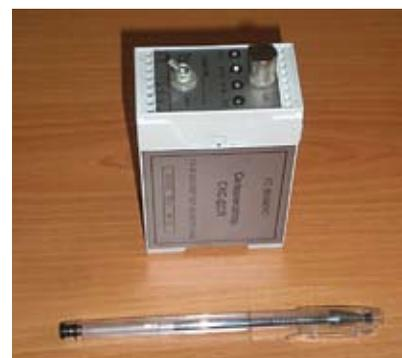
Рис. 6. Сигнализатор СКС-ДСП
