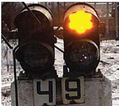
Рис. 2. Внешний вид карликового светофора
