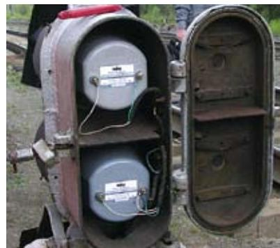
Рис. 3. Подключение модуля СЖДМ
