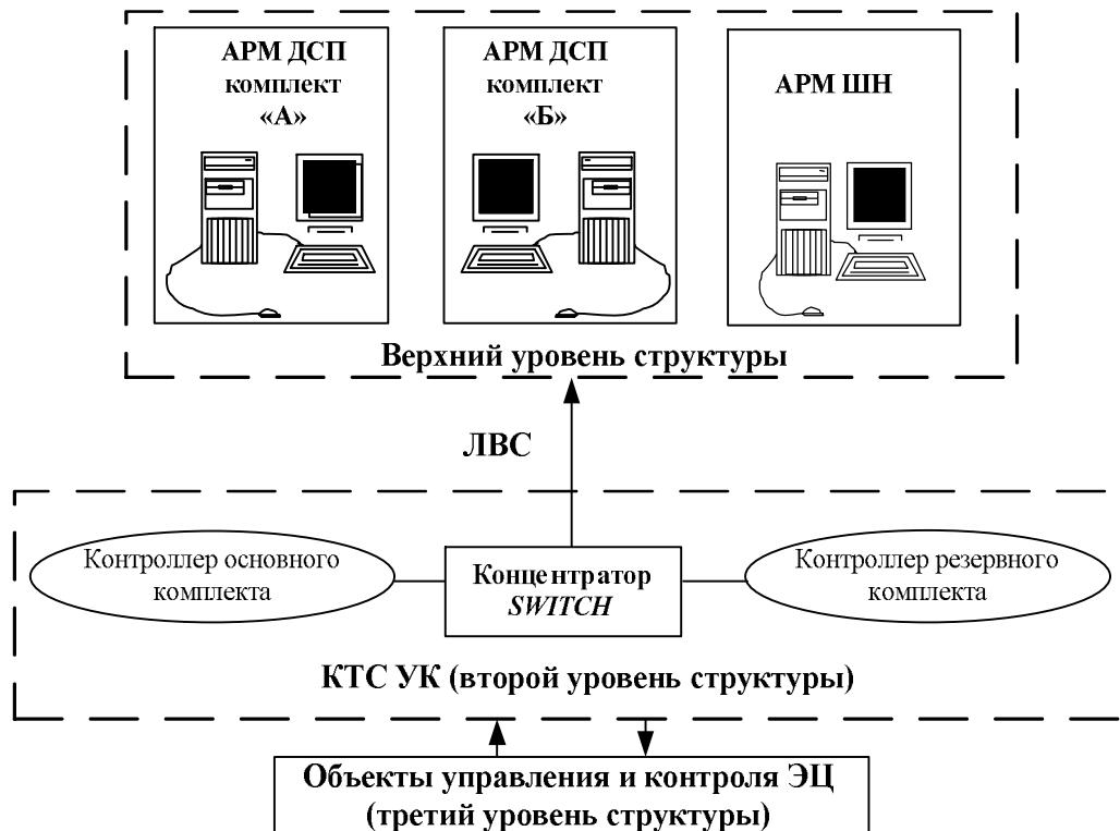
Рисунок 1. Структурная схема ЭЦ-МПК
