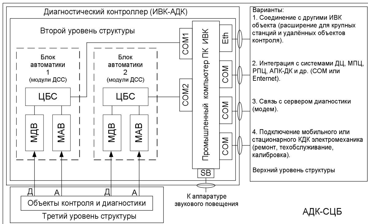
Д—дискретный контроль, А—аналоговый контроль, МДВ—модуль дискретного ввода, МАВ—модуль аналогового ввода, ЦБС—блок сопряжения с центральным компьютером, ДСС—модуль диагностики станционных систем, КДК—контрольно-диагностический комплекс
